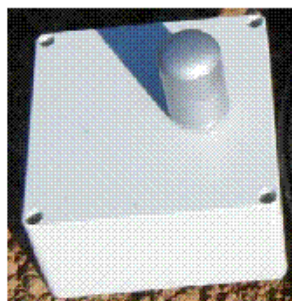
Figura 7.10. Vista de la carcasa del nodo sensor MEWiN instalada en campo.
